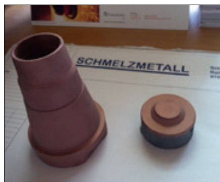
Bild 4: Formkern und Angusseinsatz in Hybridbauweise.
