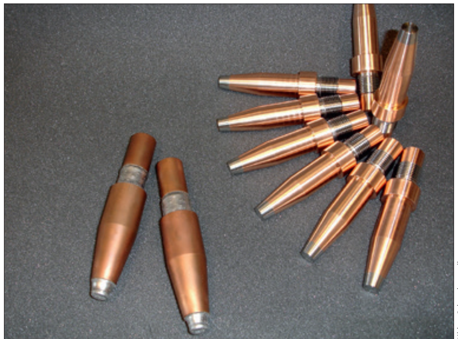
Bild 1: mittels LMD optimierte Maschinendüse.
