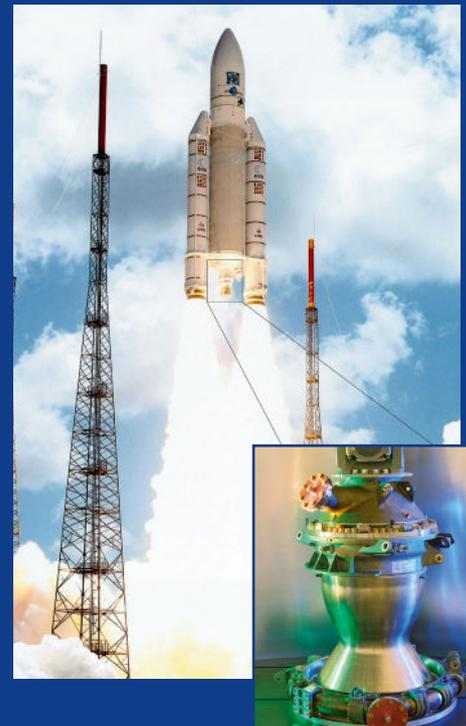
Start einer Ariane 5 Trägerrakete vom Weltraumbahnhof Kourou. Schmelzmetall ist massgeblich an der Legierung für die Brennkammern beteiligt, welche seit 1996 bei der Ariane 5 zum Einsatz kommen. (Bild EADS)
