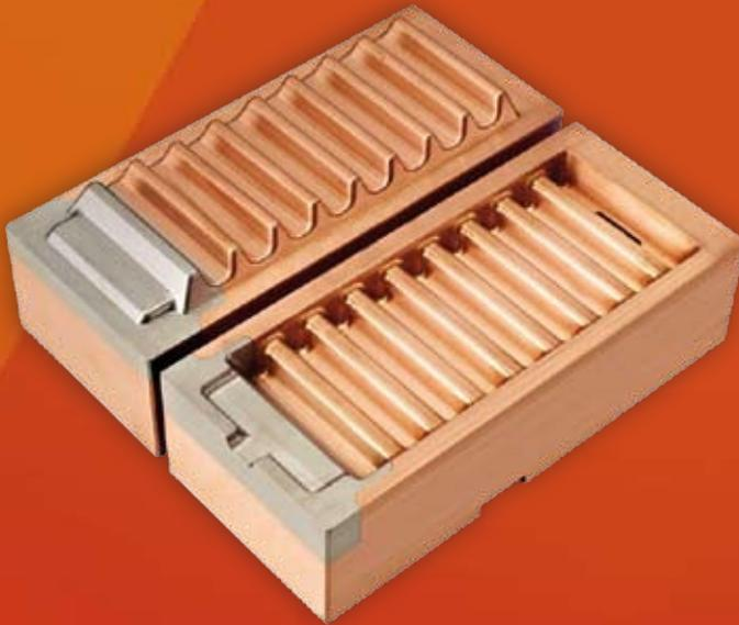
Die **MiniVent®**-Serie ist der optimale Entlüftungsblock für kleine Formen – die ideale Verbindung eines hochwärmeleitfähigen Werkstoffes mit einem verschleiß- und temperaturbeständigen Einsatz. Die optimierte Geometrie ermöglicht bei ihrer spezifischen Anwendung größere Entlüftungsquerschnitte und sichert gleichzeitig zuverlässig das Einfrieren von Aluminium, Magnesium und Zink.
